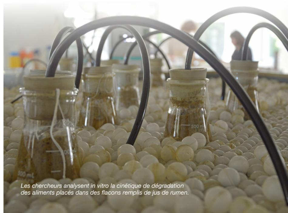
Les chercheurs analysent in vitro la cinétique de dégradation des aliments placés dans des flacons remplis de jus de rumen.
