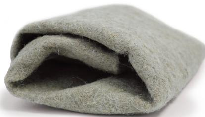
Le feutre de chanvre est utilisé dans la fabrication de matériaux composites destinés aux coques de ponts de bateau.
